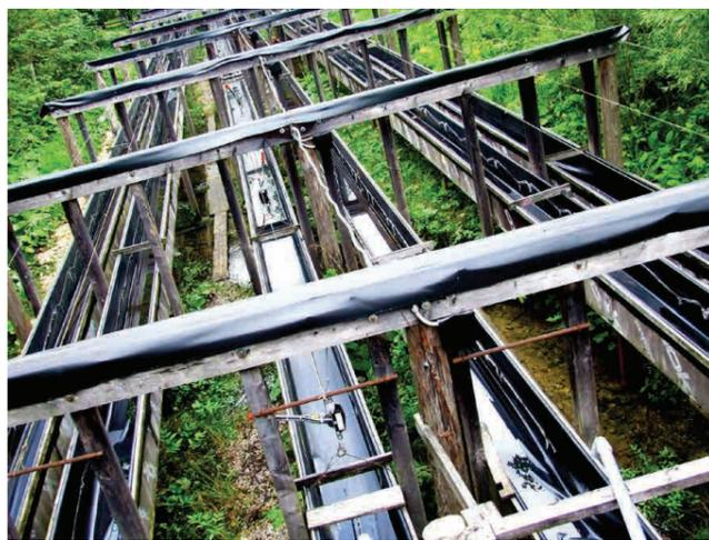
Bachläufe finden wird, so bieten die Rinnen ebendas. Gleichzeitig werden sie mit dem Bachwasser des Oberen Seebaches gespeist, es können aber auch Fließgeschwindigkeit, Wasserstand, Gefälle des Gerinnes sowie Licht- und Nährstoffverhältnisse kontrolliert werden. So untersuchte etwa die Arbeitsgruppe BERG die Auswirkungen
