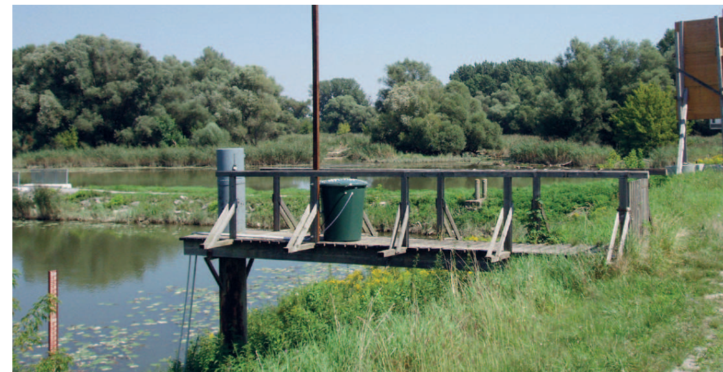
Dauermessstelle in der Lobau. Es werden neben dem Wasserstand kontinuierlich grundlegende Parameter wie Temperatur und Sauerstoffgehalt gemessen, sowie automatisch bei Hochwasser stündlich Proben zur weiteren Analyse genommen.
