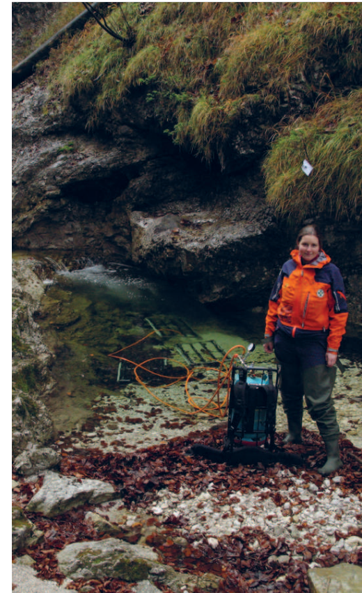
Einpeisung von Propan zur Messung des Gasaustausches am Steinbachgraben (Sabrina Hengsberger)
