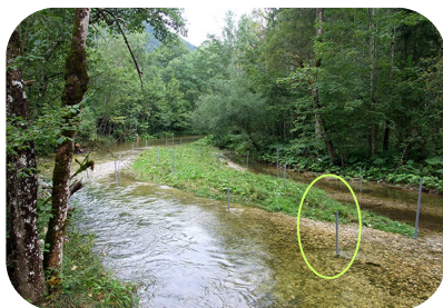
Kiesbank im Oberen Seebach mit CO 2 -Messsonden für Computersimulation
